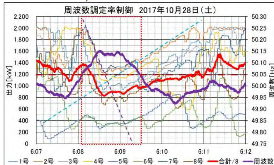
制御機能ON：2,000kW機8基の制御特性 時間幅：5分
