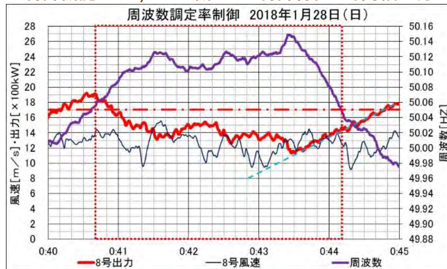
制御機能ON：2,300kW機1基の制御特性 時間幅：5分
