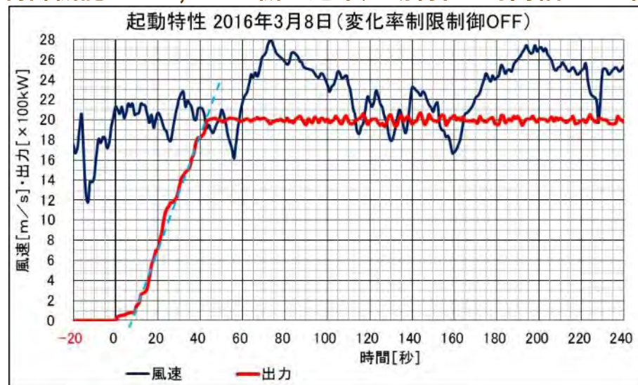
制御機能OFF: 2,000kW機の通常起動特性 時間幅=260秒
